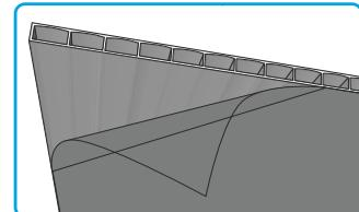
3. Заделка торцов пылезащитной
